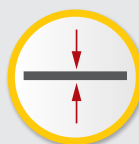
Materialdicke 0,3 mm nach DIN EN ISO 2286-3
