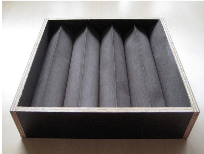
Bild 1: In Schichtholzrahmen geklebte Probe (Duette 64 Whisper) mit 4,5 Falten.
