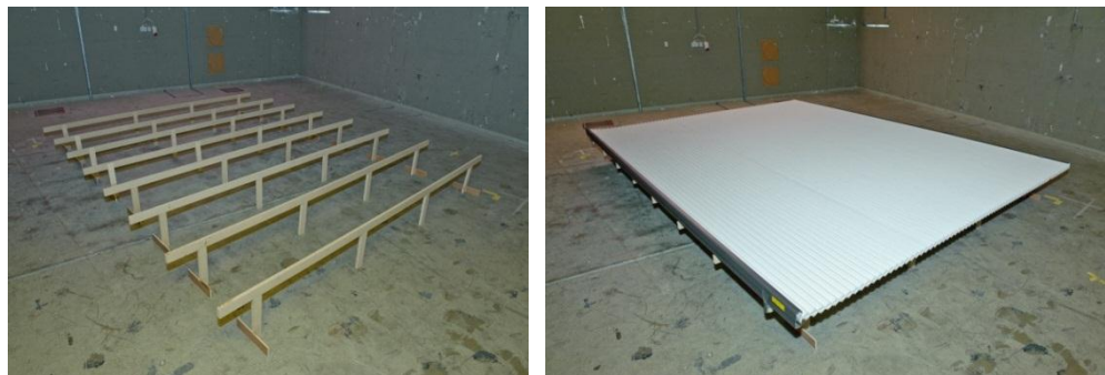
Bild 6: Einbau der Anlage über Hallraumboden aufgeständert mit umlaufend offenem Rand.
