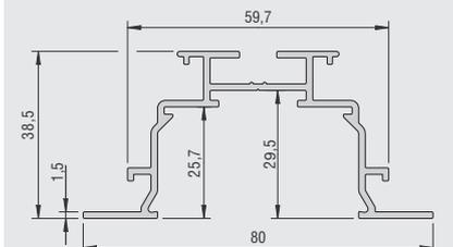
mit Halterbefestigung (abgehängte Decken)
