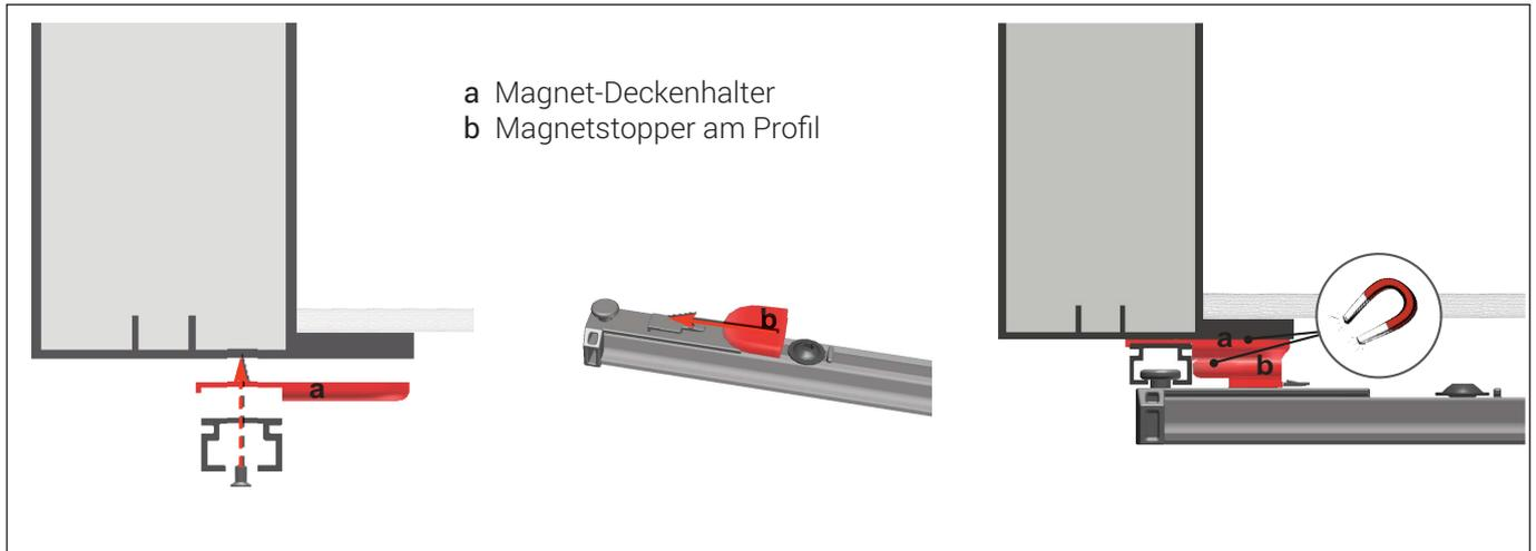
Adapter zur Vermeidung von Bohrlochern in wasserführenden Ebenen
