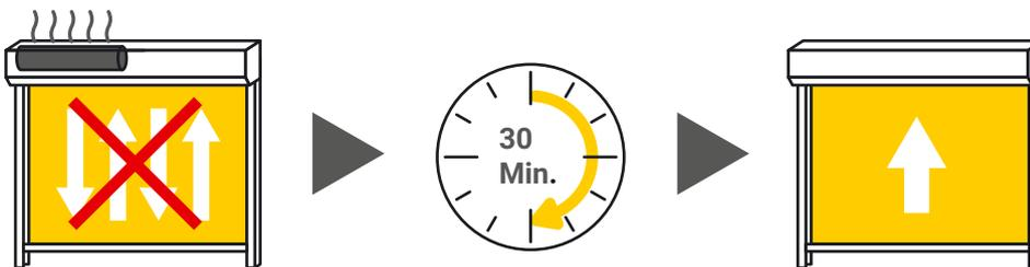
Stoffe mit Folienfenstern können sich ausdehnen, zusammenziehen und/oder wellen sowie zusammenkleben. Dies wird durch Temperatur- oder Spannungsunterschiede im Gewebe verursacht.
