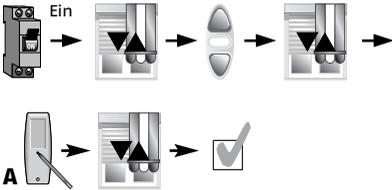
Netzspannung anlegen. Der Antrieb bestätigt mit einer kurzen **AUF-/AB-Bewegung**. Um den Antrieb zu aktivieren, drücken Sie **gleichzeitig AUF und AB**, bis der Antrieb wieder mit einer kurzen **AUF-/AB-Bewegung** bestätigt. Drücken Sie die **PROG**rammiertaste, bis der Antrieb erneut mit einer kurzen **AUF-/AB-Bewegung** bestätigt.
