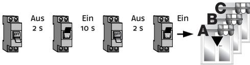
Schalten Sie die Netzspannung für **2 sec. aus**, dann wieder für **10 sec. ein**, nochmals **2 sec. aus** und anschließend wieder **ein**. Die Antriebe A, B, C bestätigen mit einer **5 sec.-Bewegung**.
