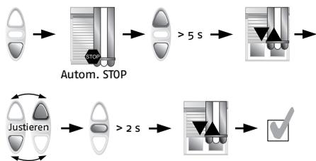
Drücken Sie **AB**, um die untere Endlage anzufahren. Warten Sie, bis der Antrieb selbstständig stoppt. Drücken Sie in dieser Position **gleichzeitig AUF und AB**, bis der Antrieb mit einer kurzen **AUF-/AB-Bewegung** bestätigt. Justieren Sie die Endlage mit **AUF bzw. AB**. Speichern Sie die Änderungen durch Drücken von **STOP**, bis der Antrieb erneut mit einer kurzen **AUF-/AB-Bewegung** bestätigt.
