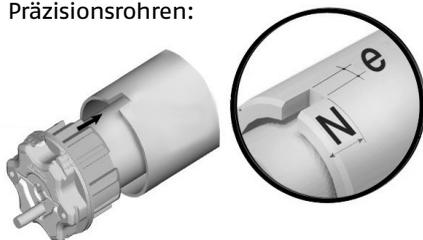
Den Antrieb dem Profil entsprechend in die Welle schieben. Achten Sie bei Verwendung eines Präzisionsrohres bitte auf die Ausklinkung für den Nocken.
