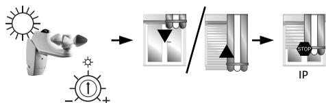
**Übersteigt die Helligkeit** den am **Soliris Sensor RTS** eingestellten Wert, fährt der Behang (nach einer Verzögerung von ca. 2 Minuten) in die **untere Endlage** oder in die eventuell einprogrammierte **Zwischenposition (IP)**.
