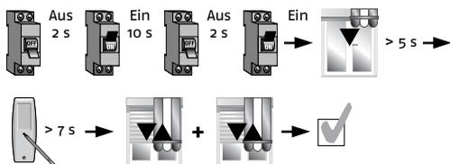
Schalten Sie die Netzspannung für **2 sec. aus**, dann wieder für **10 sec. ein**, nochmals **2 sec. aus** und anschließend wieder ein. Der Antrieb bestätigt mit einer **5 sec.-Bewegung**. Drücken Sie nun die **PROG**rammiertaste solange, bis der Antrieb das Rücksetzen **zweimal** mit einer kurzen **AUF-/AB-Bewegung** bestätigt. Alle Einstellungen müssen neu vorgenommen werden (siehe S. 2).
