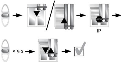
Drücken Sie **STOP**, um die Zwischenposition anzufahren. Warten Sie, bis der Antrieb selbstständig stoppt. Drücken Sie nun solange **STOP**, bis der Antrieb mit einer kurzen **AUF-/AB-Bewegung** bestätigt.
