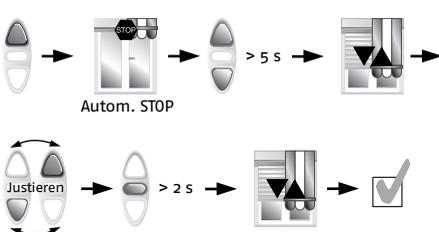
Drücken Sie **AUF**, um die obere Endlage anzufahren. Warten Sie, bis der Antrieb selbstständig stoppt. Drücken Sie in dieser Position **gleichzeitig AUF und AB**, bis der Antrieb mit einer kurzen **AUF-/AB-Bewegung** bestätigt. Justieren Sie die Endlage mit **AUF bzw. AB**. Speichern Sie die Änderungen durch Drücken von **STOP**, bis der Antrieb erneut mit einer kurzen **AUF-/AB-Bewegung** bestätigt.
