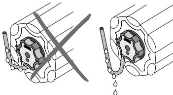
Um zu verhindern, dass Wasser in den Antrieb läuft, sollte das Anschlusskabel **in einer Schleife** nach unten verlegt werden.
