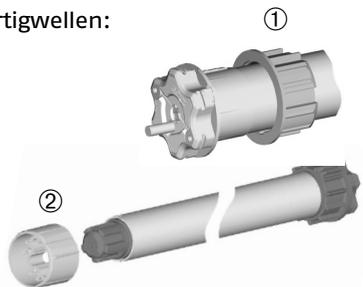
Auf den Antrieb den zur jeweiligen Antriebswelle **passenden Adapter** ① schieben. Achten Sie hierbei bitte auf den richtigen Sitz am Nocken. Anschließend den **passenden Mitnehmer** ② aufclippen.
