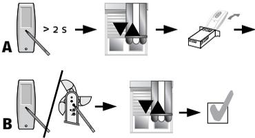
Drücken Sie am bereits eingelernten Sender (A) die **PROG**rammiertaste, bis der Antrieb mit einer kurzen **AUF-/AB-Bewegung** bestätigt. Anschließend an dem Sender (B, C, ...) bzw. Sensor, den Sie neu einlernen wollen, die **PROG**rammiertaste drücken, bis der Antrieb erneut mit einer kurzen **AUF-/AB-Bewegung** bestätigt.
