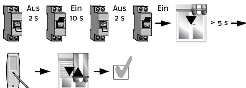
Schalten Sie die Netzspannung für **2 sec. aus**, dann wieder für **10 sec. ein**, nochmals **2 sec. aus** und anschließend wieder ein. Der Antrieb bestätigt mit einer **5 sec.-Bewegung**. Drücken Sie nun am neuen Sender kurz die **PROG**rammiertaste. Der Antrieb bestätigt das Einlernen des neuen Senders mit einer kurzen **AUF-/AB-Bewegung**.
