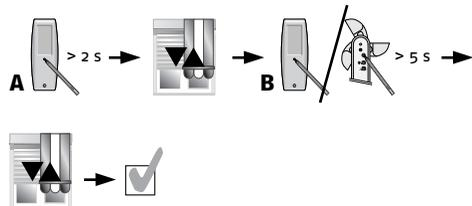
Drücken Sie am bereits eingelernten Sender (A), den sie nicht löschen wollen, die **PROG**rammiertaste, bis der Antrieb mit einer kurzen **AUF-/AB-Bewegung** bestätigt. Danach an dem Sender (B, C, ...) bzw. Sensor, den Sie löschen wollen, die **PROG**rammiertaste drücken, bis der Antrieb erneut mit einer kurzen **AUF-/AB-Bewegung** bestätigt.
