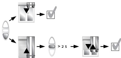
Prüfen Sie die Drehrichtung durch kurzes Drücken von **AB**. Fährt der Behang in die **AB-Richtung**, ist die Drehrichtung richtig eingestellt. Fährt der Behang in die **AUF-Richtung**, müssen Sie die Drehrichtung ändern. Drücken Sie zum Ändern der Drehrichtung **STOP**, bis der Antrieb mit einer kurzen **AUF-/AB-Bewegung** bestätigt.
